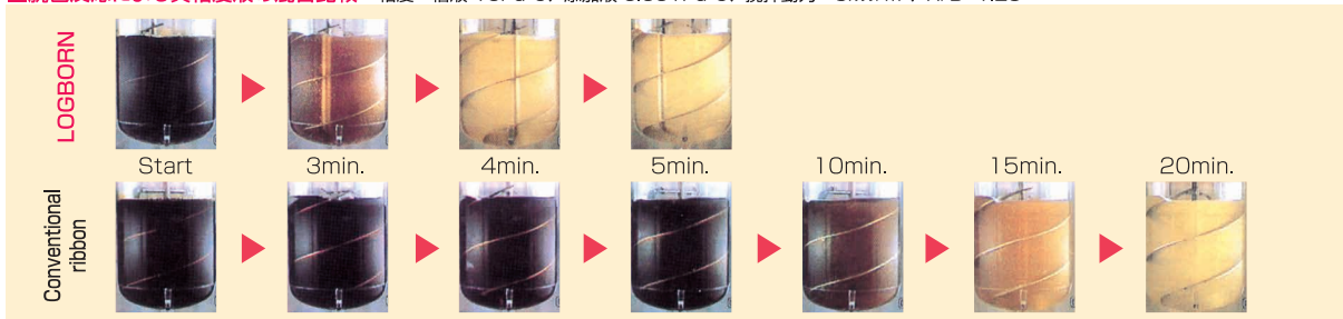
■超高粘度液の混合過程 粘度：3,000Pa・s、攪拌動力：6kW/m 3 、H/D=1.25
