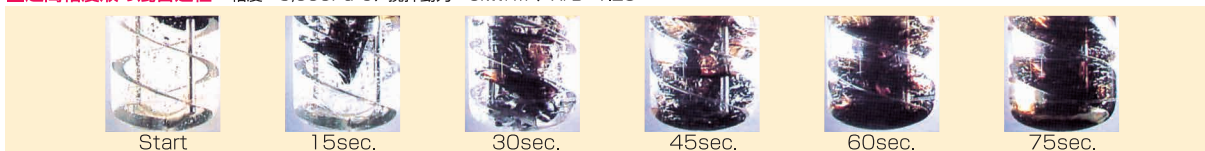
■超高粘度液の混合過程 粘度：3,000Pa・s、攪拌動力：6kW/m 3 、H/D=1.25
